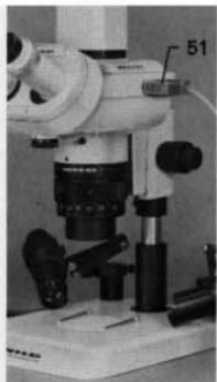
Relier le câble de mesure photométrique à la prise coaxiale «SENSOR» (76) d'une part et d'autre part à la prise (50) du Photomakroskop. Relier le câble de commande à la prise multiple «CONTROL» (79) et d'autre part à la prise multiple (51) du Photomakroskop.
